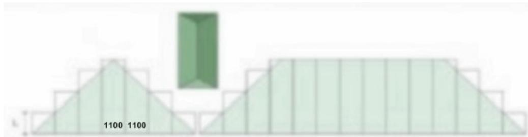
In cazul acoperisului reprezentat in figura de mai sus, se recomanda sa se faca un desen la scara pentru fiecare suprafata de acoperis pentru a determina numarul si lungimile necesare.
