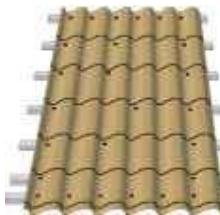
Sipcile din lemn de calitate buna sau din profil de tabla, se fixeaza la distanta de 35 cm una de cealalta, iar prima sipca (de la streasina) se fixeaza la o distanta mai mica in functie de configuratia asterealei.
